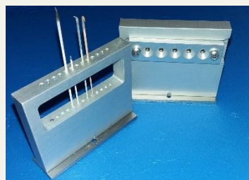
Porte-capillaire et porte- échantillon plan pour le SAXS
